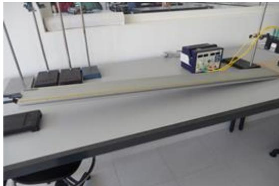
Figura 1: Montagem experimental para determinação da energia cinética ao longo de um plano inclinado
