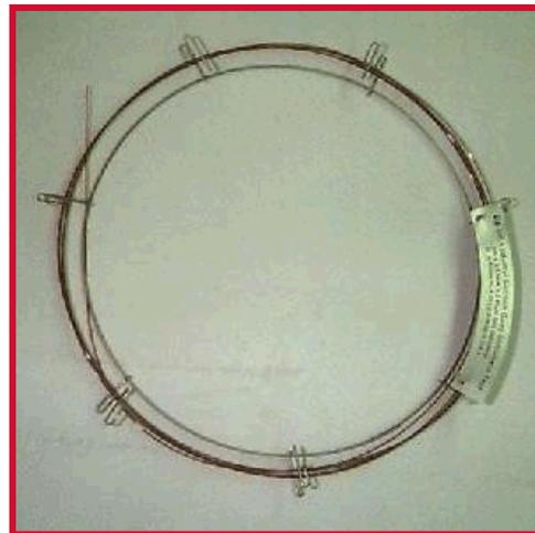
As colunas empacotadas podem variar de comprimento desde de 120 a 150 cm, com diâmetros de 2 – 9 mm.
