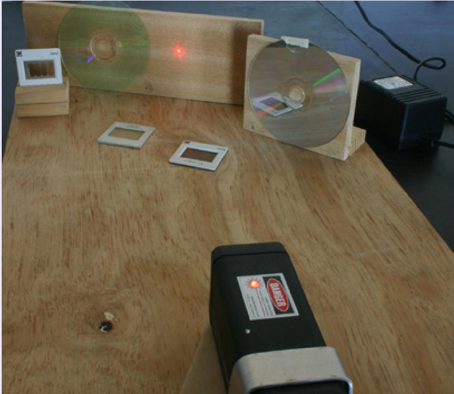
Figura 1 - Mesa óptica MO3 em configuração para estudos de difracção
