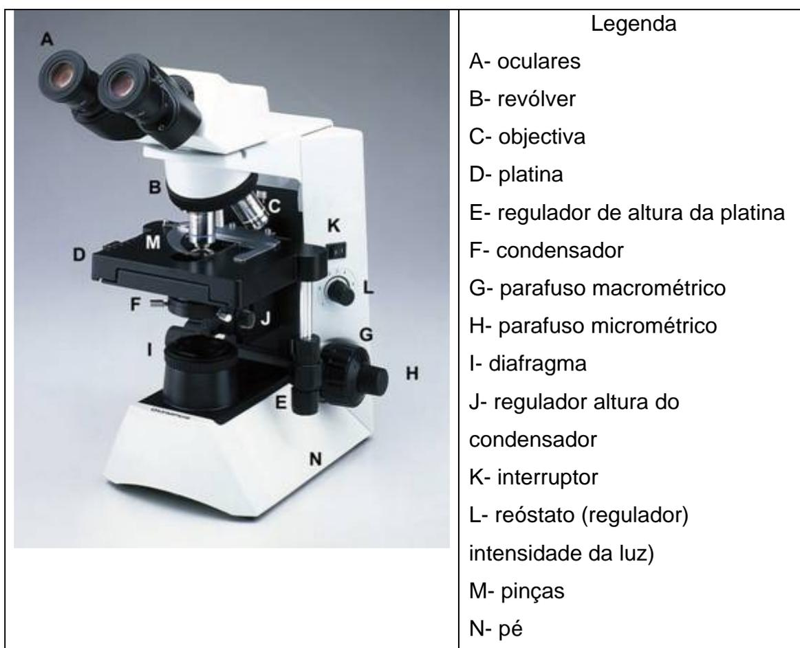
Fig.1 – Microscópio óptico composto.
