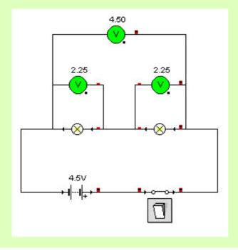
2. Que relação há entre a tensão nos extremos da associação em paralelo das duas lâmpadas e as tensões nas extremidades de cada uma das lâmpadas? Esquematiza o circuito e escreve os respectivos valores.
