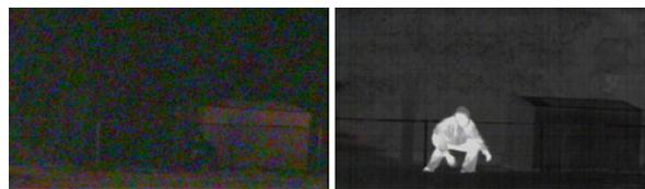
À esquerda, uma foto nocturna (máquina apenas sensível à luz visível... que era muito pouca). À direita, uma foto tirada praticamente no mesmo instante, com máquina sensível à radiação infravermelha. Como o corpo humano emite radiação infravermelha, foi detectado pela máquina...
