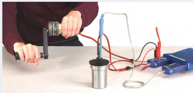
A intensidade da corrente e a diferença de potencial no resistor, mergulhado na água do calorímetro, foram medidas com sensores. A temperatura da água foi também medida ao longo do tempo, com um sensor de temperatura.
