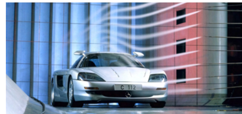
Apenas cerca de 25% da energia obtida a partir dos combustíveis e ar surge como energia cinética de um automóvel. Na foto, um protótipo num túnel de vento para estudo das forças de resistência do ar.
