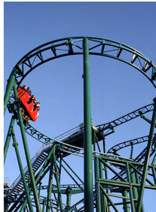
O trabalho da força gravítica no movimento do carrinho entre dois pontos da montanha russa, a diferentes alturas, depende apenas do desnível entre esses dois pontos.
